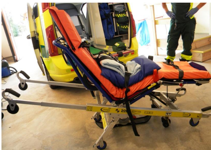
Fig 20: Brancard. Tous les dispositifs embarqués dans l'ambulance doivent supporter une force d'accélération de 20G.
