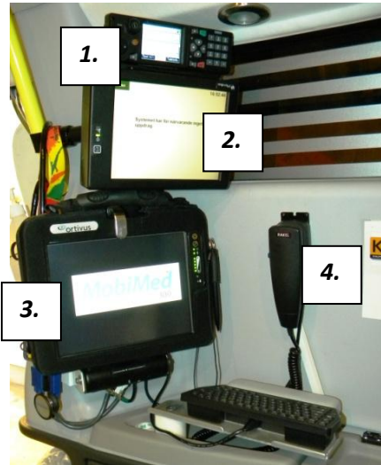
Fig 18: 1. Appareil polycom, 2. Informatique pour la saisie et la transmissions des données, 3. Monitoring 4. Téléphone pour le contact avec l'hôpital receveur.
